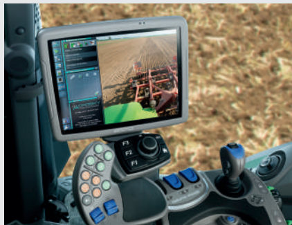
מצלמה משולבת עם מצב מסך מלא אוטומטי (למשל בנסיעה לאחור) לסקירה כללית ולבטיחות.
