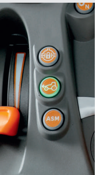
4WD המופעל באופן אלקטרו-הידראולי ונעילת דיפרנציאל הכוללת ASM
