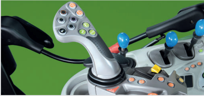
דגמי ה-TTV מופעלים באמצעות ידית היגוי MaxCom. ניתן להקצות מבין ארבעה לחצנים לכל פונקציה.
