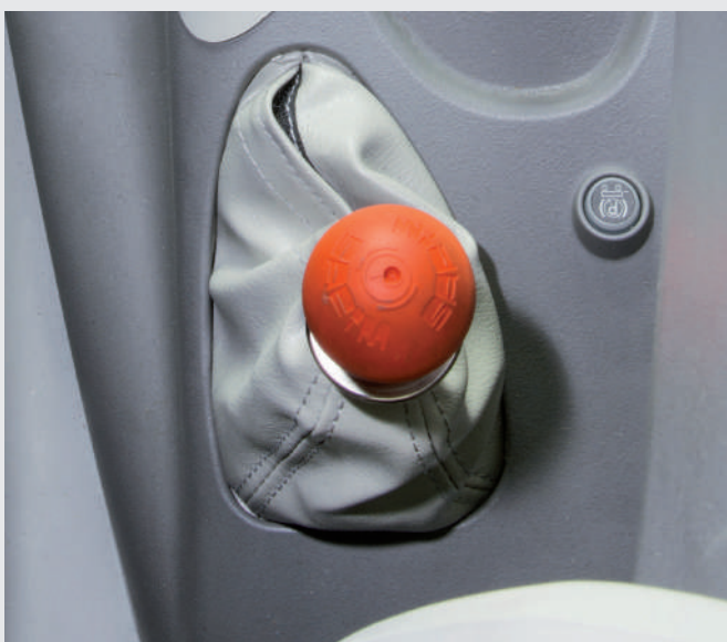
בלם חניה הידראולי. מצב מאובטח בכל מקום בו תחנו את הטרקטור החדש שלכם מסדרת Series 6.
