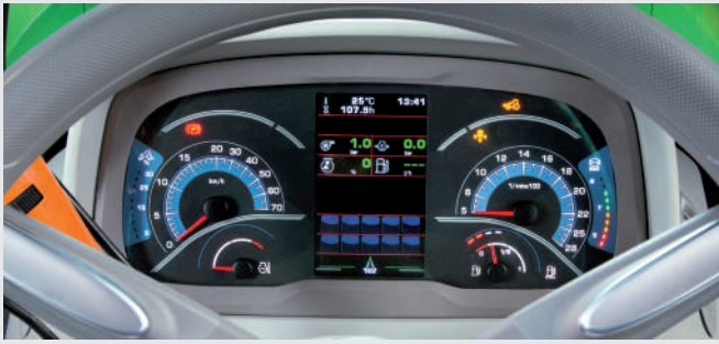
לוח מכשירים מתקדם ביותר עם InfoCentrePro חדש: מסך צבעוני LCD בגודל 5" עם חולציה גבוהה להצגת נתונים בשיא האיכות בהתאמה אישית למשתמש.
