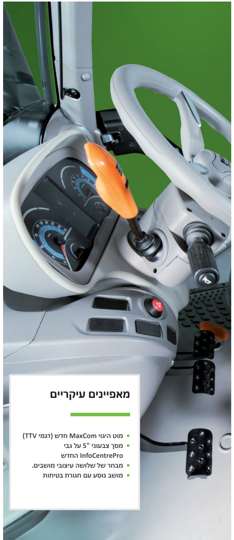
לוח מכשירים מתקדם ביותר עם InfoCentrePro חדש: מסך צבעוני LCD בגודל 5" עם חולציה גבוהה להצגת נתונים בשיא האיכות בהתאמה אישית למשתמש.
