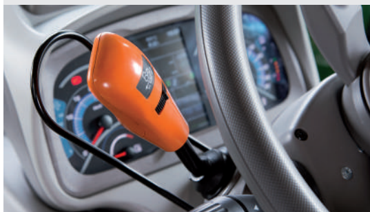
↑ Powershuttle עם 5 הגדרות כוונן לשינוי כיוון מבלי להפריע למומנט.
