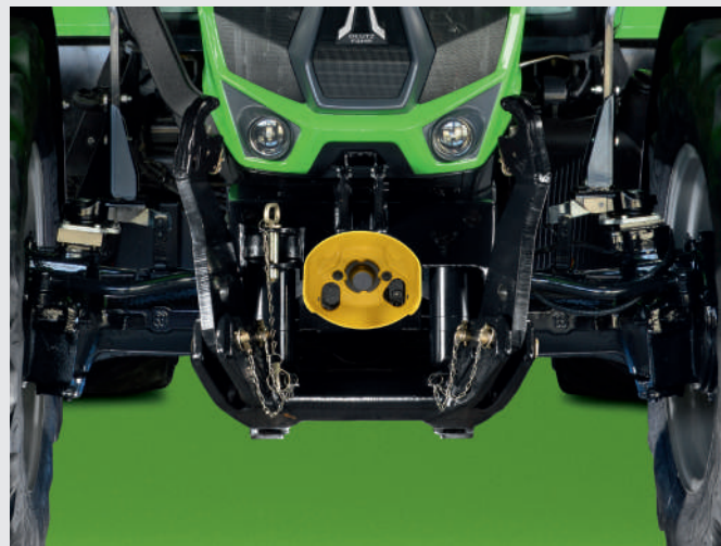
החיבור הקדמי העוצמתי יכול לשאת עד 2,880 ק"ג. זמין גם: ה-ComfortPack עם ססתום בקרה נוסף בחזית.
