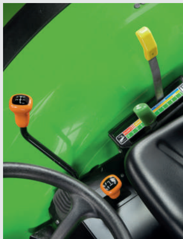
ידידת החלפת ההילוכים ורכיבי בקרה אחרים מסומנים באופן בולט בקוד צבעים ומסודרים בטווח גישה נוח סביב מושב הנהג.
