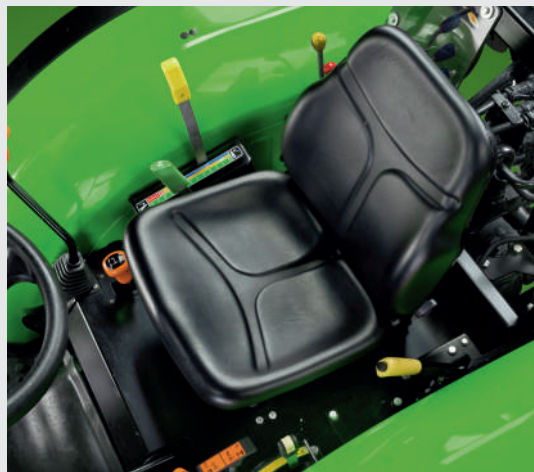
מושב נהג על מתלה מכני עם כוונן אופקי וכוונן משקל ידני.
