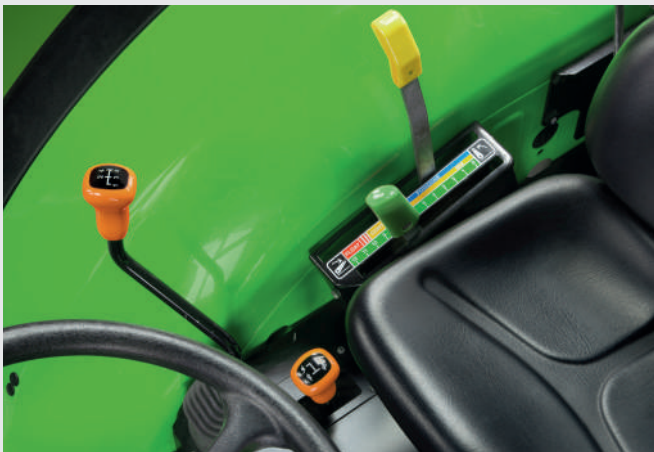
↑ בקרת ממסרת הרמת רתם אחורי מכנית - מערכת הרמת רתם מכנית מדויקת וקלה לשימוש.
