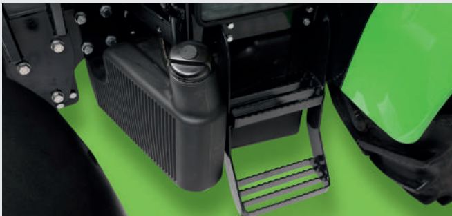
מכל דלק בעל קיבולת של עד 130 ליטר, להבטחת משכי עבודה ארוכים.
