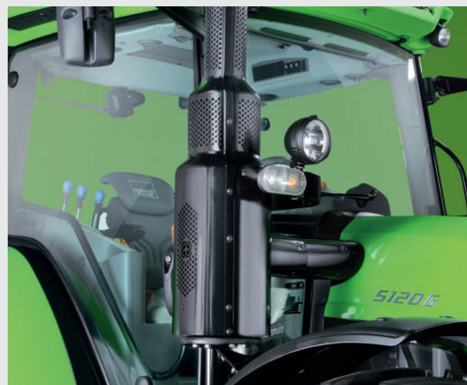
טכנולוגיית טיפול בגזי פליטה הכוללת ממיר קטליטי מחמצן (DOC) עבור מנועי Stage III B או ממיר קטליטי בררני להפחתת מזהמים (SCR) עבור מנועי Stage IV
