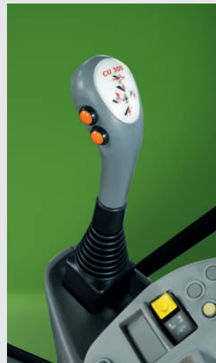
ידית ההפעלה של המעמיס הקדמי עם לחצני פאוורשיפט, עצור וסע, מערכת היגוי מהיר SDD ...
