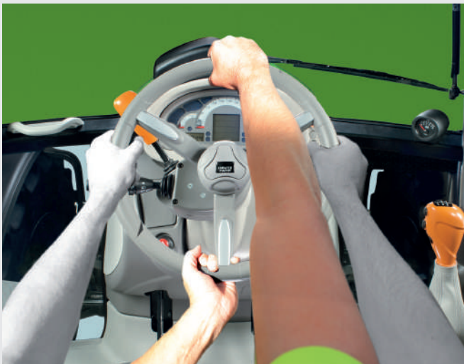
מערכת ההיגוי המהירה SDD. מחצית הסיבובים של גלגל ההגה, הספק היגוי כפול.
