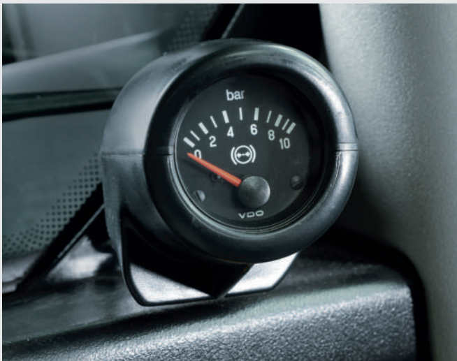
מערכת בלם אוויר (אופציה) לבלימה אמינה של ציוד כבד הנגרר מאחור.
