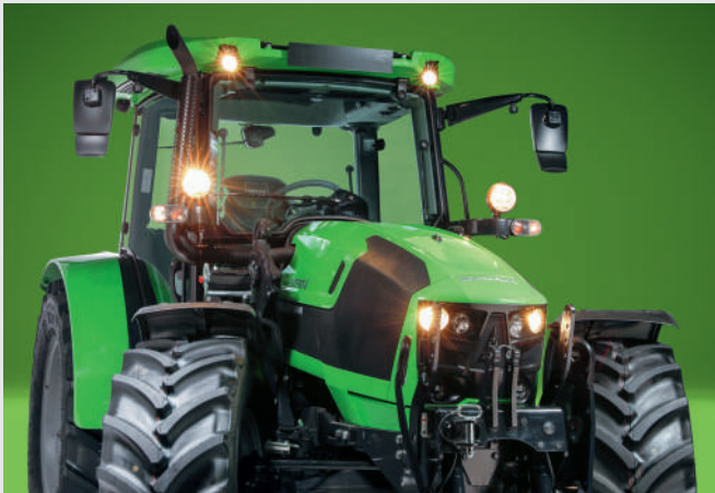
↑ להשגת ראות מיטבית בתנאי מזג אוויר גרועים, שישה פנסי עבודה בגג ובעמודי צד. שני פנסי עבודה ראשיים במכסה המנוע.
