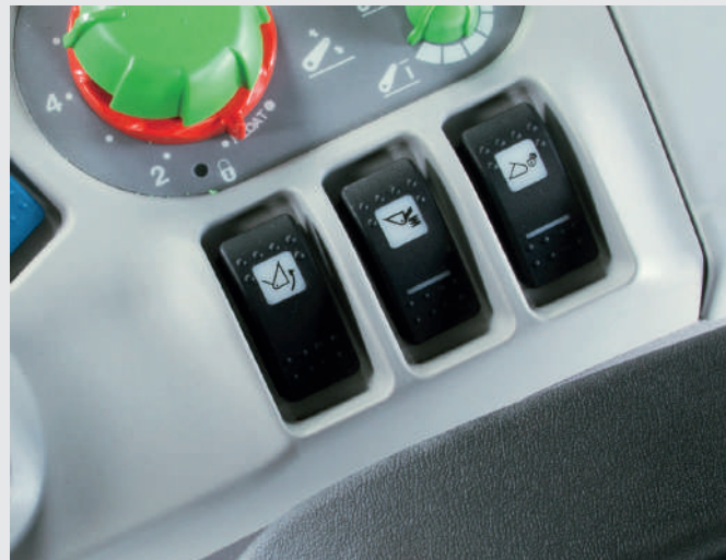
... וכל אמצעי הבקרה להפעלת המעמיס הקדמי משולבים במלואם ונוחים לגישה.
