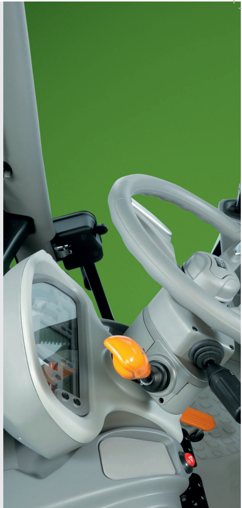
↑ רמת רעידות תא הנהג הופחתה בשיעור של עד 40%. מתלה "Hydro" ובעמודי צד. "Silent-Block".
