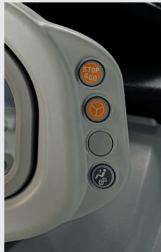
ידית ההפעלה של המעמיס הקדמי עם לחצני פאוורשיפט, עצור וסע, מערכת היגוי מהיר SDD ...
