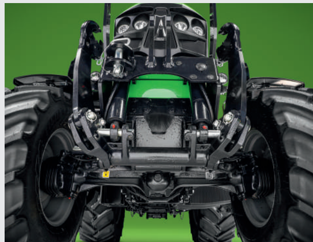
רתם קדמי ו-PTO. כושר הרמה של 2,100 ק"ג ו-PTO 1,000.
