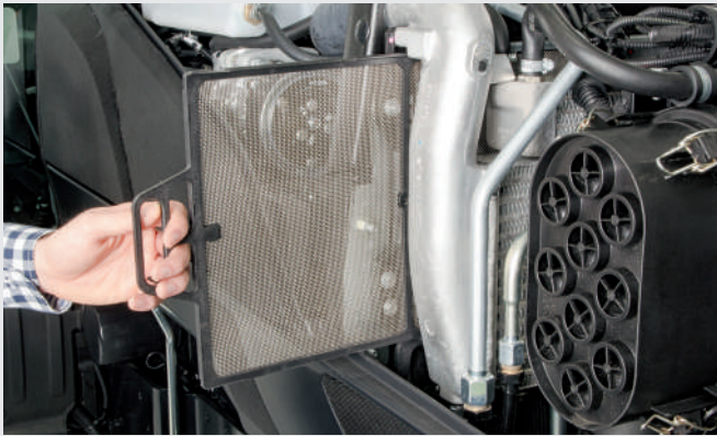
מערכת הקירור הגדולה שתוכננה מחדש, זרימת האוויר המשופרת ומסנן האוויר PowerCore מסייעים כולם ליעילות המנוע.
