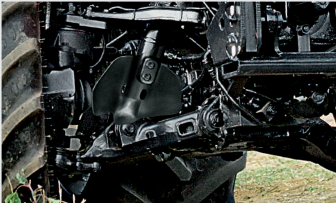
↑ מתלה עצמאי של הגלגלים הקדמיים עם תכנון המבוסס על שתי זרועות בקרה.
