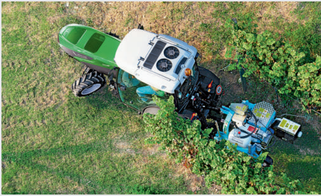
↑ רדיוס סיבוב טוב יותר בגלל גיאומטריה צרה יותר של מסגרת הסרן הקדמי.
