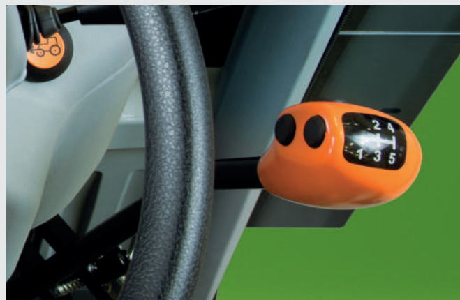
↑ פאורשיפט. החלפת הילוכים ללא שימוש במצמד, בלחיצת לחצן.
