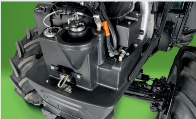
אפשר למלא את מכל הדלק ששולב בתמך הסרן הקדמי גם כשמכסה תא המנוע סגור, בעוד שמכל העזר ממוקם מתחת לשלדה.
