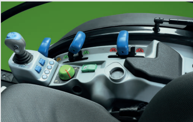
↑ ידית הפעלה עבור יחידות בקרה אלקטרוניות נוספות, ממוקמת באופן ארגונומי.
