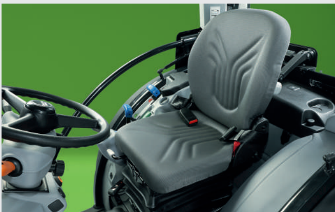
↑ זמינות גרסאות מושבים עם מתלה פניאומטי או מכני ומגוון של אפשרויות כונון שונות.
