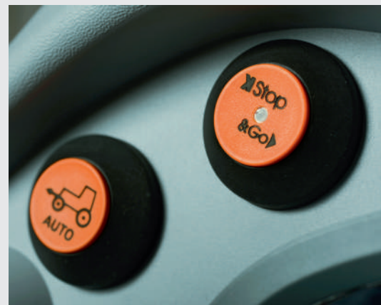
↑ עצור וסע. התחלת נסיעה ועצירה נוחות ללא שילוב המצמד
