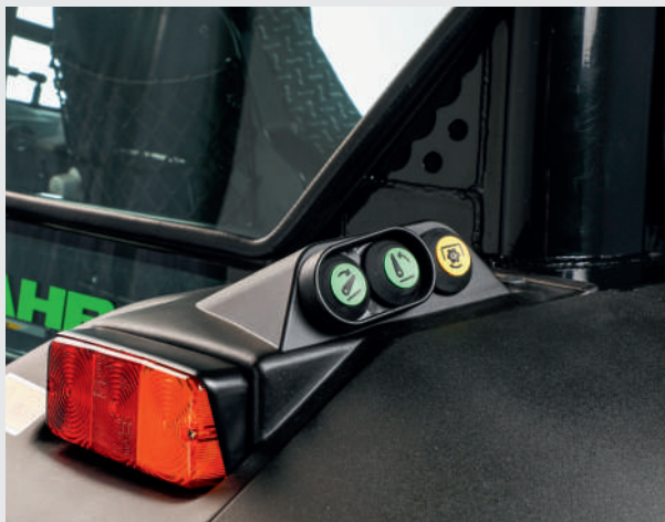
בקריות נוחות עבור הרתם האחורי וה-PTO על מגן הבוץ האחורי.
