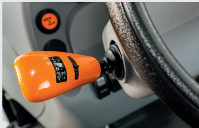
ידית Powershuttle עם תפוקוד SenseClutch.
