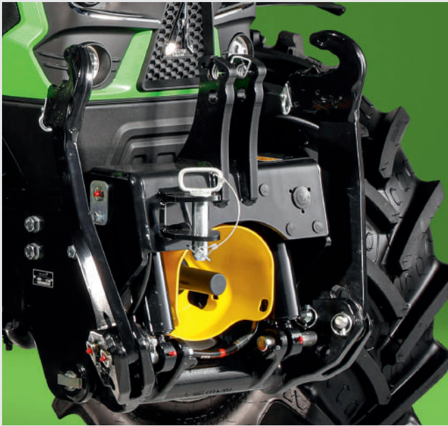
↑ על-פי דרישה, דגמי סדרה 5D יכולים להיות מצוידים ברתם הקדמי Sauter החדש.
