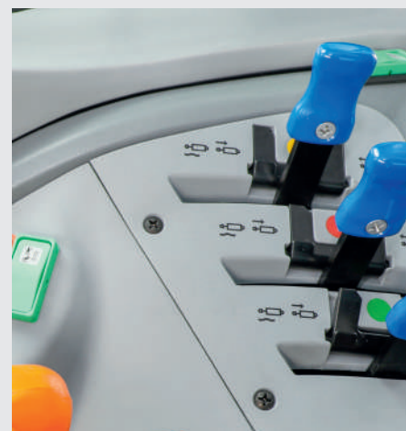
עד 3 יחידות בקרת עזר מכניות, הממוקמות על קונסולת הצד.
