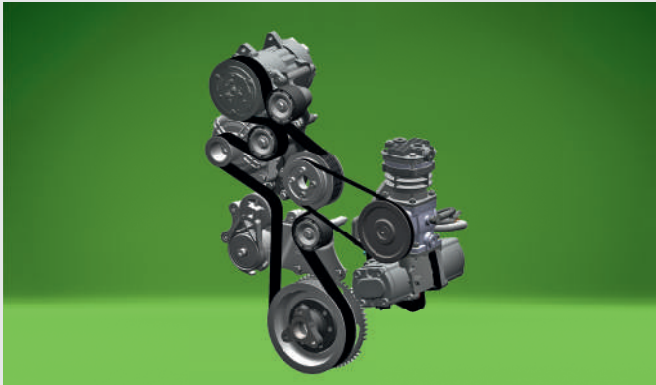
רצועת ההנעה בעלת הכוונון העצמי היא רצועת פול-V נטולת תחזוקה, עם מותחן אוטומטי. אין סכנת החלקה של הרצועה הגורמת לחימום-יתר.
