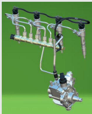
מערכת הזרקה החדשנית מסוג מסילה משותפת מבטיחה שריפת דלק יעילה מאוד.
