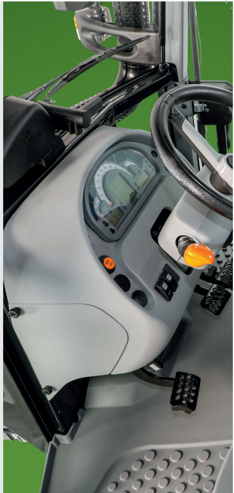
אפשר למקם את גלגל ההגה הטלסקופי המתכוון גם בהטיה כדי להתאימו לנהג.
