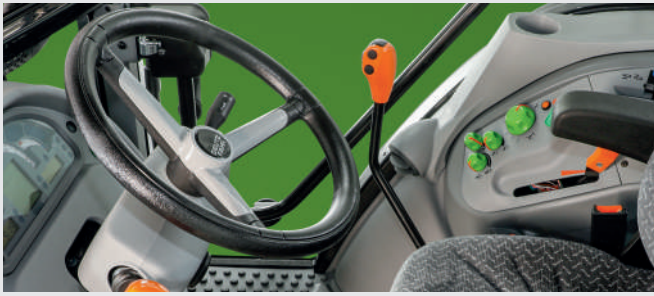
אפשר למקם את גלגל ההגה הטלסקופי המתכוון גם בהטיה כדי להתאימו לנהג.
