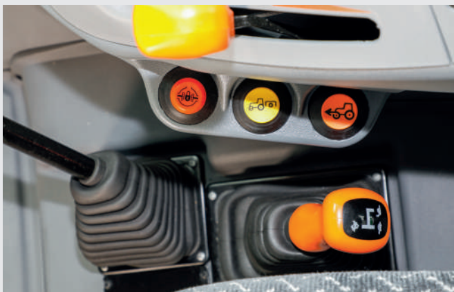
שילוב אלקטרו-הידראולי של ההנעה הכפולה ונעילת הדיפרנציאל (LS) (GS-I).
