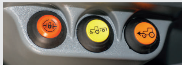
ההפעלה האלקטרו-הידראולית של ה-PTO מבטיחה שילוב נוח והתחלת פעולה רכה של ה-PTO.
