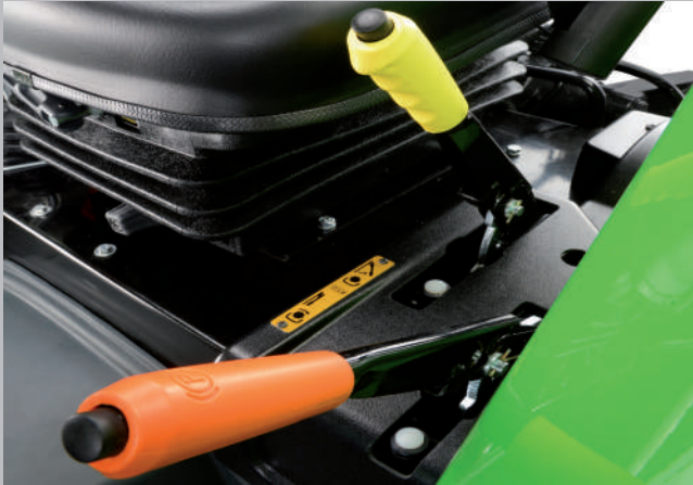
אמצעי הבקרה של בלם החניה ומפרש הכוח (PTO) נמצאים בטווח גישה נוח בצד שמאל.
