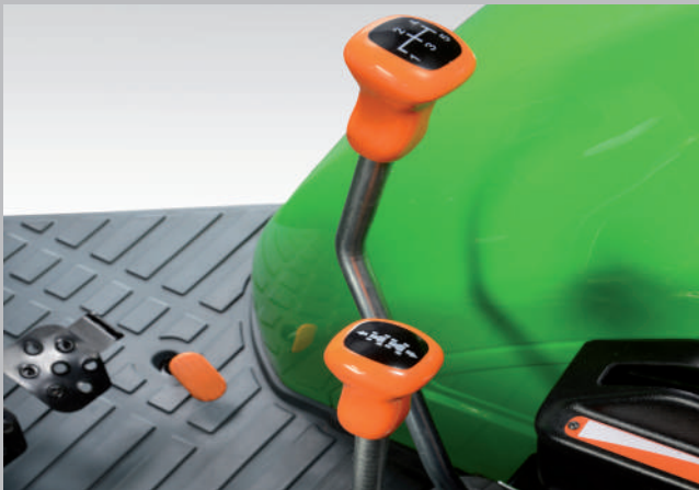
אמצעי הבקרה של תיבת ההילוכים, המצערת הידנית, הגדרות מהירות סיבובי המנוע, הרתם האחורי והבקרות ההידראוליות נמצאים בטווח גישה נוח מימין לנהג.
