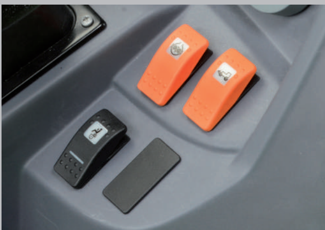
אופציה של הפעלה או אלקטרו-הידראולית של ההינע ארבעה-גלגלים ונועל הדיפרנציאל.
